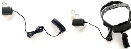
그림 3.3. 두 가지 배터리 팩 충전 방법
