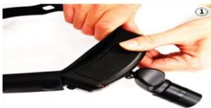
그림 3.2 배터리 팩 분리 방법
